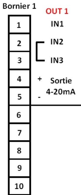
**Exemple de raccordement 2 fils pour la voie n°1, bornier 1 (OUT 1) :**
